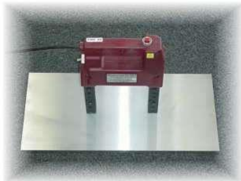
Plaque de mesure de l'aimantation selon NF EN ISO 9934-3
