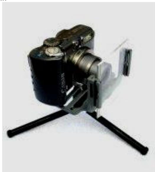
La position relative de l'appareil par rapport à la plaque est d'une grande importance : l'axe focal de l'objectif doit 'pointer' perpendiculairement au milieu de la cale à photographier et ce afin d'éviter toute distorsion notamment si le cliché est utilisé pour réaliser un dimensionnement des indications sur PSM5.
