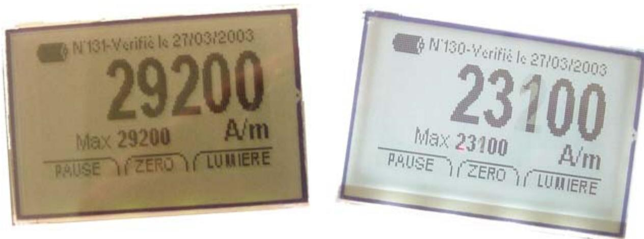
Rétroéclairage vert (gauche) et blanc (droite) : voir caractéristiques électriques pour l'affectation de l'autonomie par le rétroéclairage.
