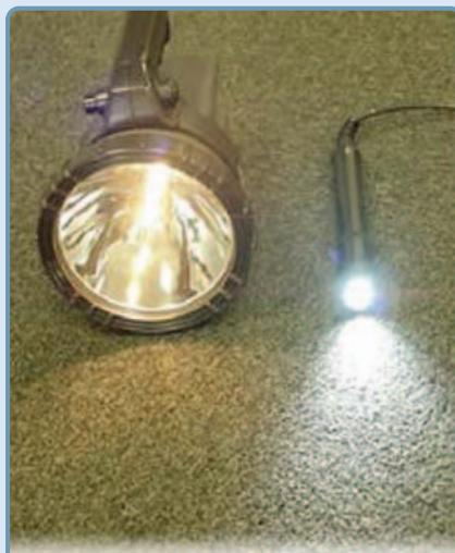
Figure 9 : éclairage lampe à filament tungstène sur batterie (env. 3 000 °K) et éclairage lampe LED (diode) ultrablanc (env. 6 500 °K).
